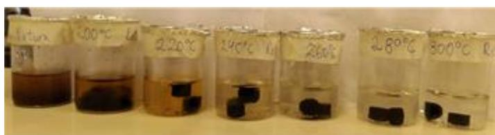
Figura 2. Estabilidade dos pellets de biocarvão em água após 13 dias.
